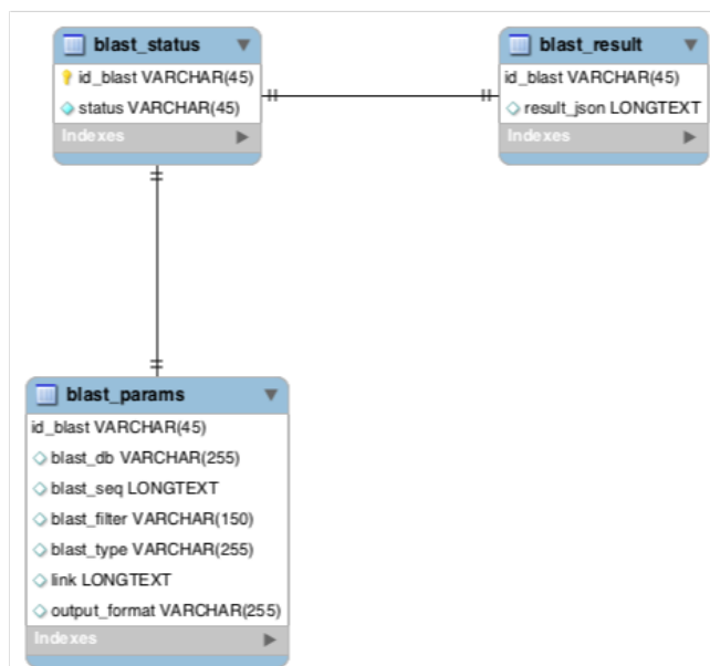
Fig. 2. blast_manager database schema
