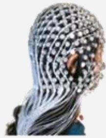
EEG device EGI 128 geodesic sensor net
